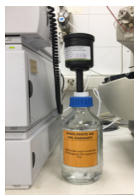
Rys. 33. Przykład bezpiecznych nakrętek dla butelek VOC (Źródło: otrzymano od laboratorium uczestniczącego w projekcie)
