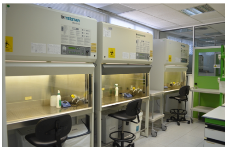
Rys. 32. Szafki biobezpieczeństwa klasy II z technologią przepływu laminarnego (Źródło: otrzymano od laboratorium uczestniczącego w projekcie)
