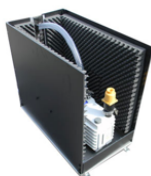
Rys. 30. Przykład pudetka izolującego hałas do pomp próżniowych (Źródło: otrzymano od laboratorium uczestniczącego w projekcie)
